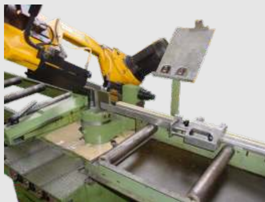
Geleideprofiel 40 voorzien van aanslag type 40-VOR met verlengstuk H-500
