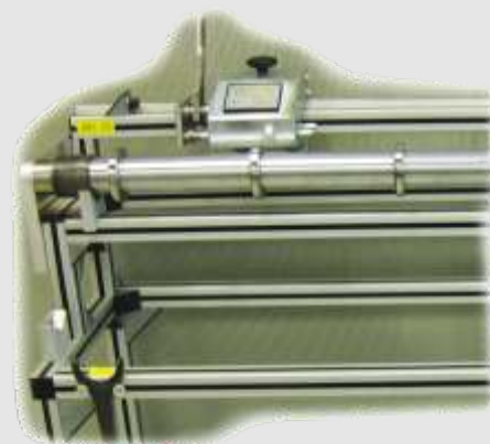
Digitale aanslag voorzien van een extra pal voor het afstellen van snijmesses.
