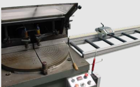
Aluminium afkortzaag voorzien van rollen baan type RB80 voorzien van geleideprofiel 40-B6 met aanslag type 40-DIR
