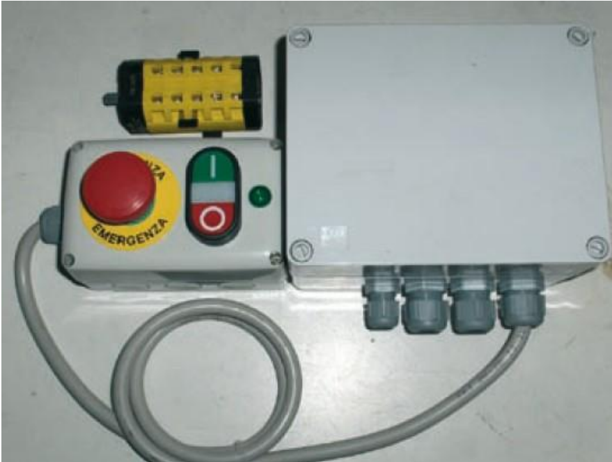
Schakelkast met nulspanningsbeveiliging, noodstop en 24 volt trafo
